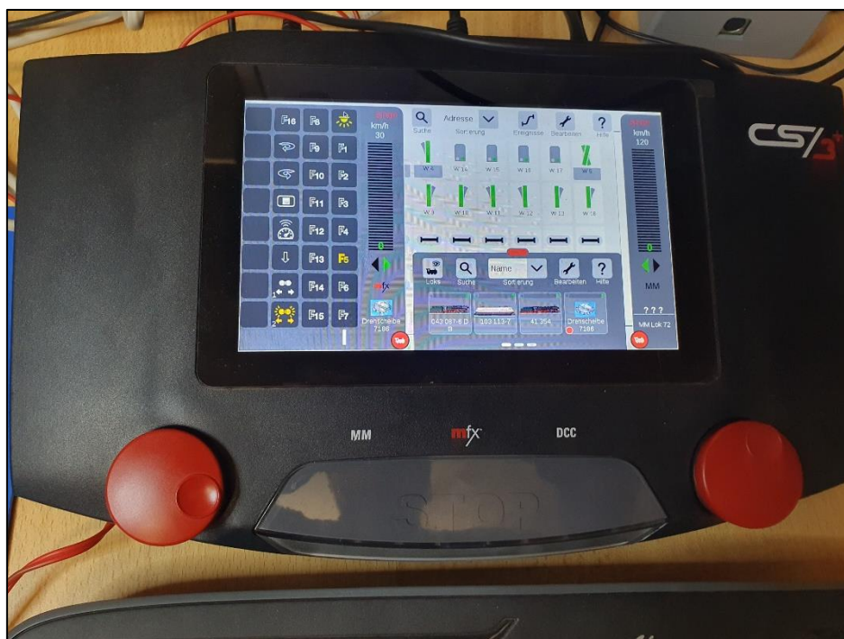
Abbildung 14-6: CS3® zeigt aktuelles Gleis 5, dass die Leuchte an der Kabine an ist sowie Gleispersignal 1 an der Kabine auf ROT und gegenüber auf WEISS
