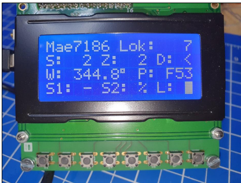
Abbildung 13-7: mbc-94 als Steuereinheit für den mbc-85
