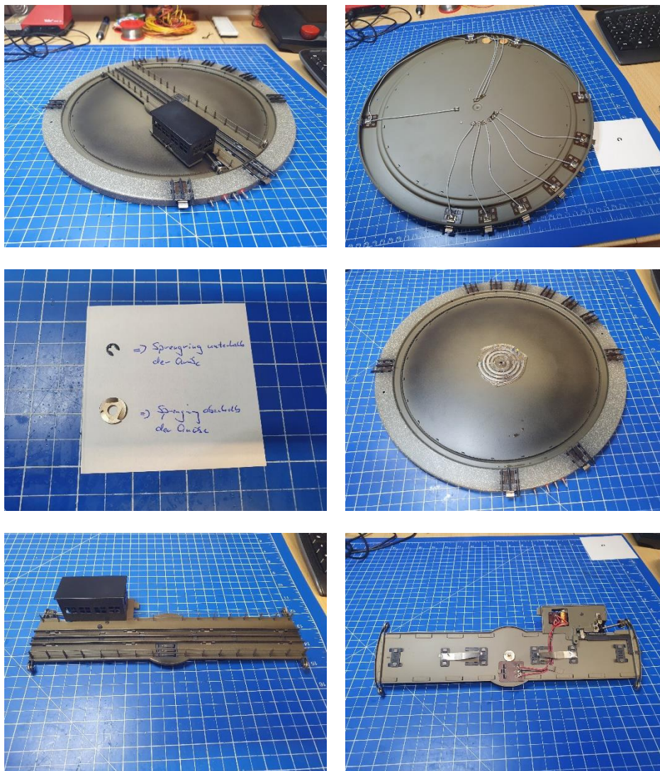
Abbildung 9-1: Zerlegen und Reinigen der Drehscheibe
